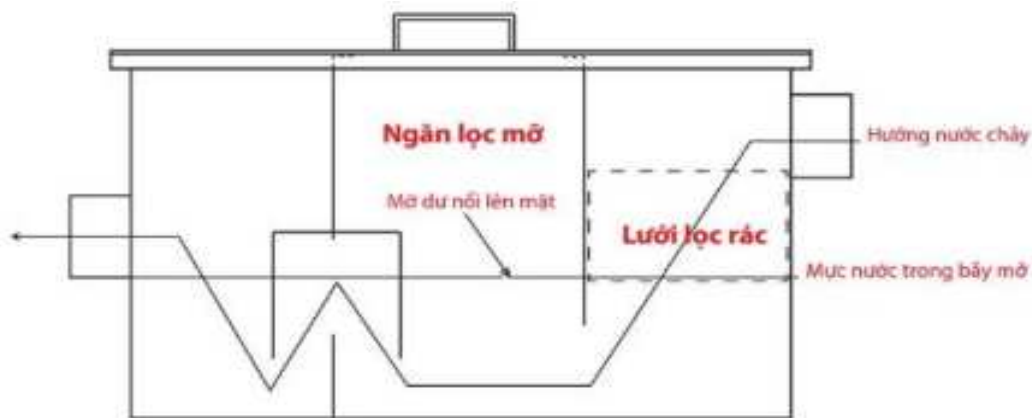
Hình 3.3: Cấu tạo bể tách dầu mỡ
